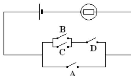
On souhaite réaliser un montage électronique comportant les entrées A, B, C et D, ainsi que des portes logiques, et une sortie S matérialisée par une lampe.
