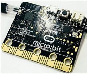
Cette carte embarque un microcontrôleur qui est un système complet tenant dans une seule puce : SoC (System On Chip). On y trouve de la mémoire RAM, de la mémoire FLASH, un microprocesseur, des périphériques d'interface, un circuit radio.
