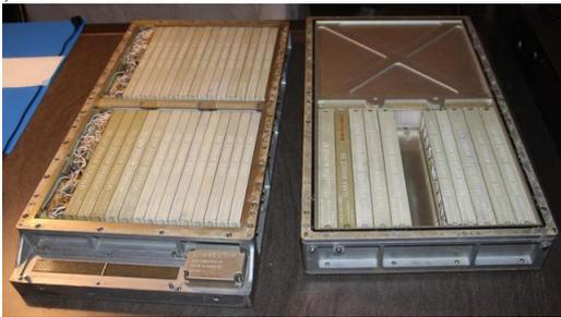
Celui-ci ne pèse que 32kg et possède une consommation électrique suffisamment faible pour être embarqué dans une capsule spatiale fonctionnant sur batteries. Ces progrès ont été possibles grâce notamment au recours aux circuits intégrés (CI) pour réaliser des fonctions logiques : Il a fallu plus de 5 000 portes NOR pour constituer l'unité de calcul de l'AGC. Voici une photo de l'une d'entre elles :
